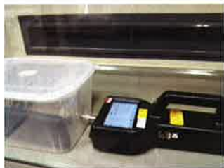
家庭用品を適用した布から放散される微小粒子状物質の計測
