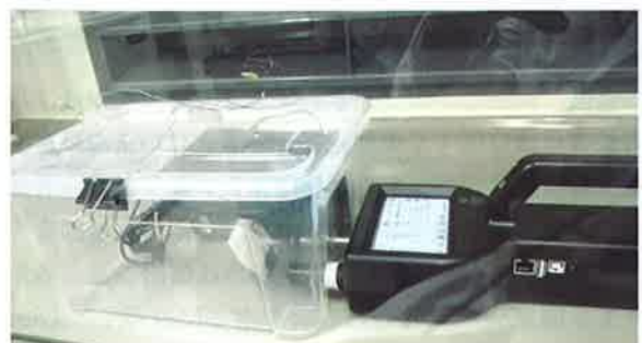
家庭用品から放散される微小粒子状物質の測定の様子
