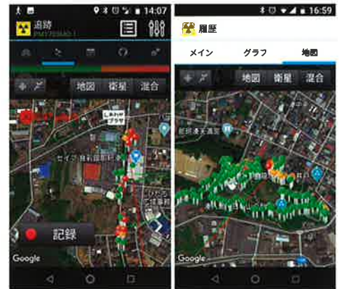
スマホ連動型POLIMASTER PM1703M-1BTによるホットスポット探索の実測例。測定場所は、ひたちなか市神敷台けやき並木（左）と同市那珂湊公園（右）。色分け線量区分：赤0.5 \mu Sv/h以上、橙0.23～0.5 \mu Sv/h、緑0.23 \mu Sv/h以下
