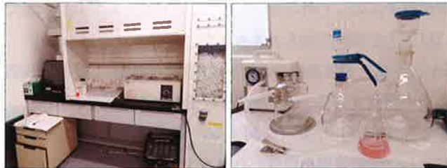
測定試料の前処理のために必要な電気炉、ドラフトチャンバー、沈殿濾過装置など
